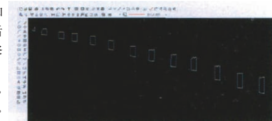
复材分析软件正向建模后直接生成的下料图形
